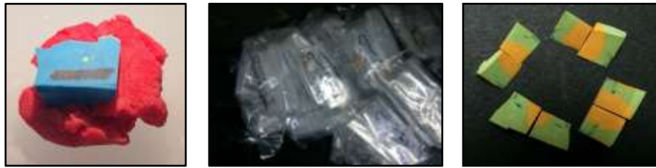
شكل (49) حفظ العينات في أكياسها و تثبيتها بشكل عامودي تحت العدسة بواسطة المطاط الصناعي
