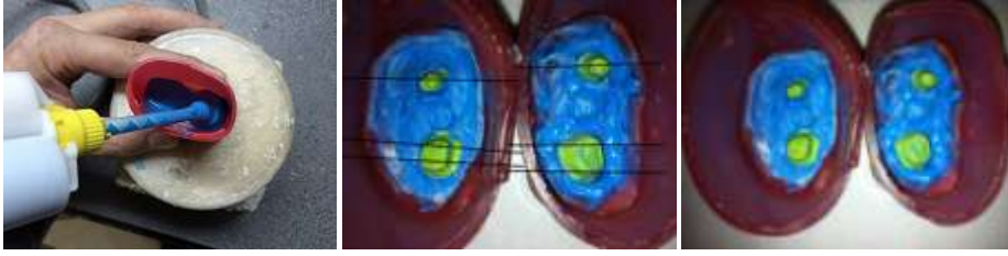
شكل (46) تغليب الكتلة المطاطية الناتجة و صبها بنفس المطاط الرخو مختلف اللون
