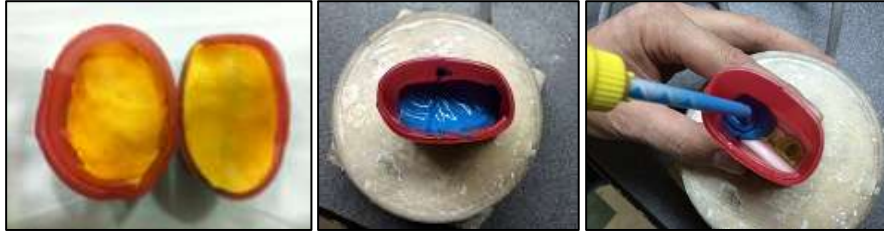
شكل (44) صب الثخانة المطاطية المعلبة بالمطاط الإضافي الرخو مختلف اللون و دعمه بالمطاط القاسي
