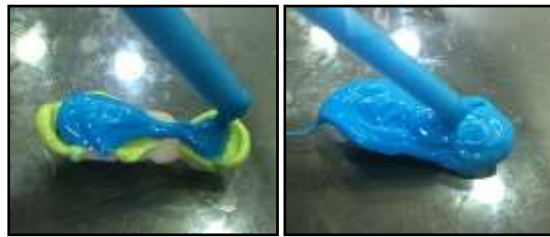
شكل (57) حقن المطاط السيليكوني الإضافي منخفض اللزوجة (تقنية النسخ المضاعف التقليدية)
