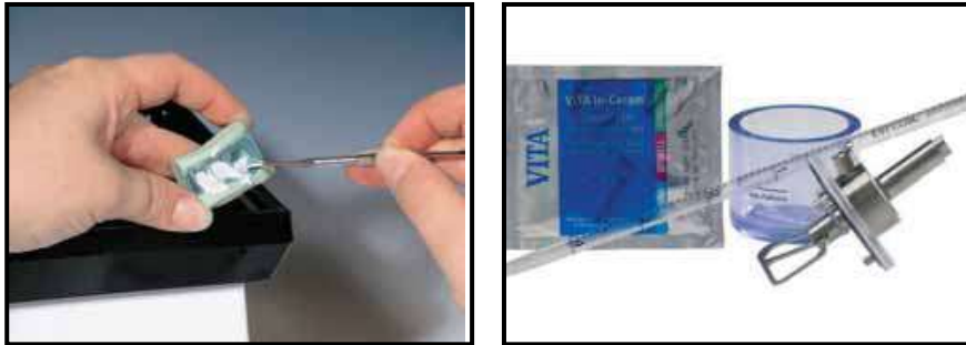
شكل (27) صب القوالب المطاطية بمادة Special Plaster
