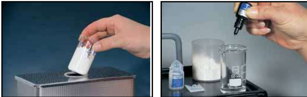
شكل (29) مزج Zirconia Powder مع السائل Mixing liquide بواسطة جهاز الهزاز الكهربائي
